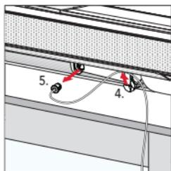
4. Schnur aus Führung lösen
