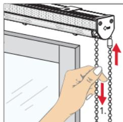
1. Bedienkette bis zum Anschlag des Ketenschlosses hochziehen
