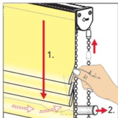
1. Raffrollobehang durch Ziehen an der Bedienungskette ganz nach unten lassen
